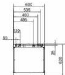
Габаритные и присоединительные размеры NIBE 1155
